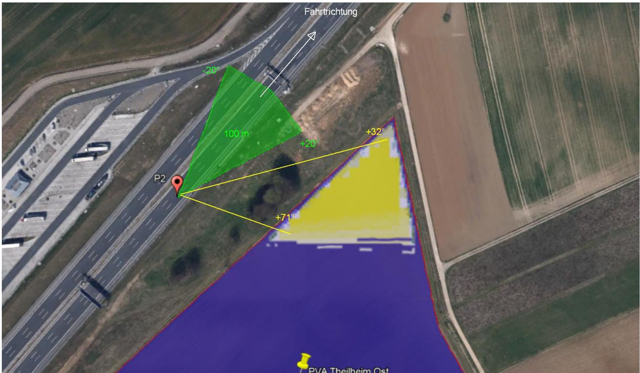
Bild 4.3.2: Simulation am Messpunkt P2 (Quelle: Google Earth/SolPEG)
