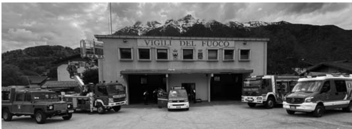
Eine Auswahl von Einsatzfahrzeugen vor der Feuerwache Vigolo Vattaro. Der ganze Stolz ist das nur 1,9m breite Fahrzeug mit dem Rettungskorb, der zum Einsatz in den engen Gassen bis auf 20m ausgefahren werden kann.
